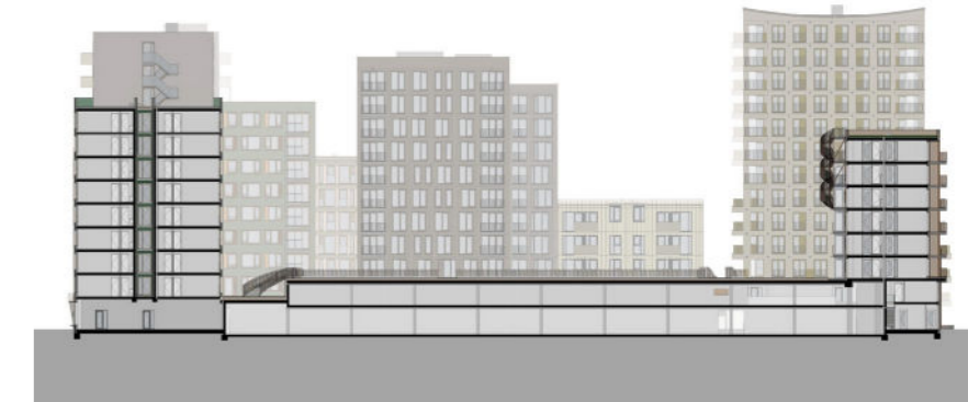
Doorsnede met parkeergarage in bouwblok 11 ©GROUPA
